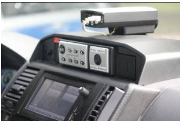
(Fotos: Innenansicht der Displayeinheit mit Kamera und Darstellung der Videobilder im Fahrzeug)
